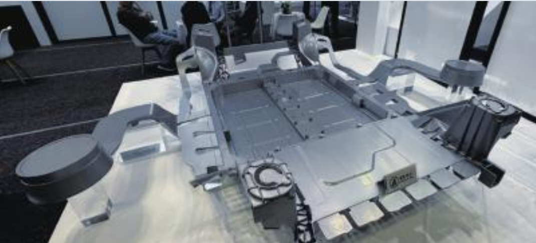
[도표 5] LK와 체리(Chery)가 시험 제작한 언더 바디
