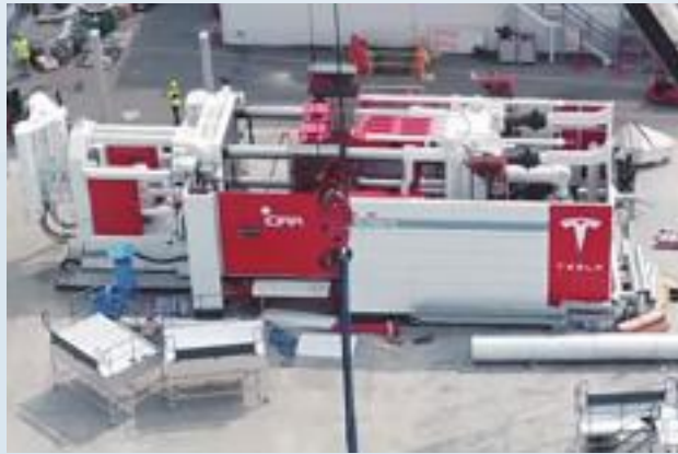
이드라의 테슬라 Model Y 후방 언더바디용 6,100톤급 기계. 출처: 이드라
